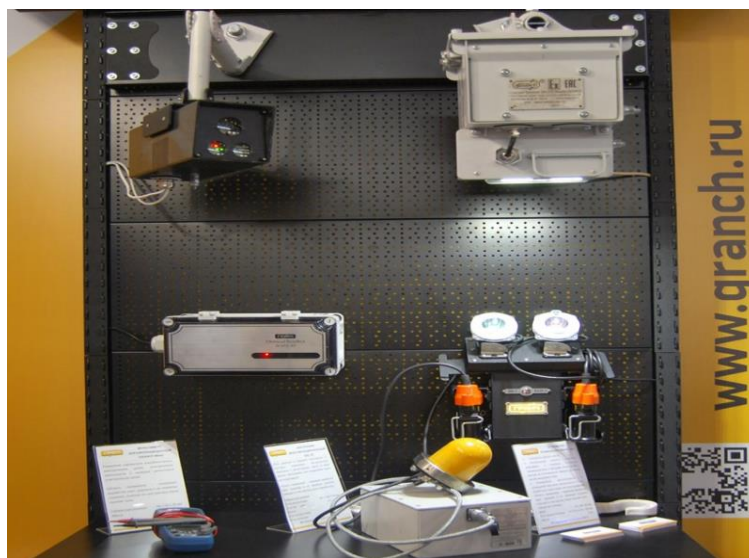
Рис. 2. Оборудование рудничной многофункциональной системы безопасности и связи «SBGPS-R»
